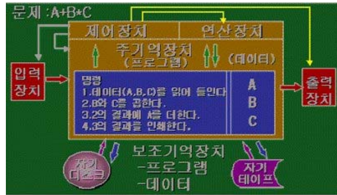
[그림 3-2] 컴퓨터 명령어의 수행과정 : 명령어를 나타내는 프로그램과 처리될 데이터가 주기억장치에 저장된다. 하나의 명령어를 제어장치로 가져가 해석한 후 해석된 명령어의 지시에 따라 주기억장치에서 데이터를 연산장치로 옮긴 후 연산을 수행한다. 수행된 결과는 주기억장치를 통해 출력장치로 보내거나 보조기억장치에 저장된다.
